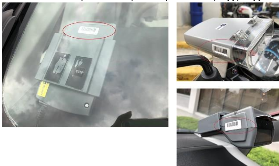
Зураг 46. ЭТС-ийн төхөөрөмж тээврийн хэрэгсэл дээр суурьлуулсан байдал
